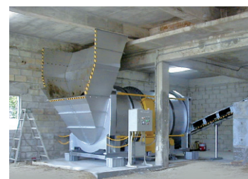
沖縄の離島で家畜糞を有効活用すべく導入された堆肥化用の混合装置「Cモード」 写真提供／株式会社ミライエ
